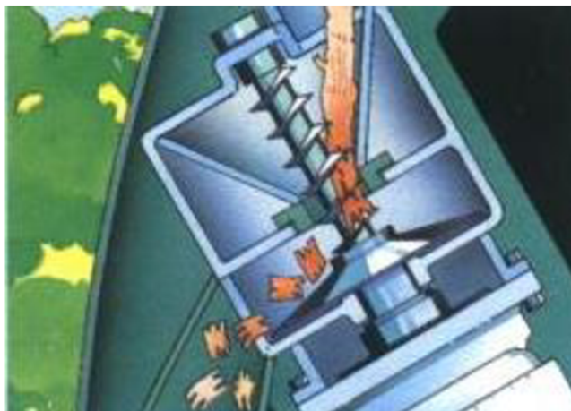
Obr. 6 Šnekový drtící mechanismus [18]
