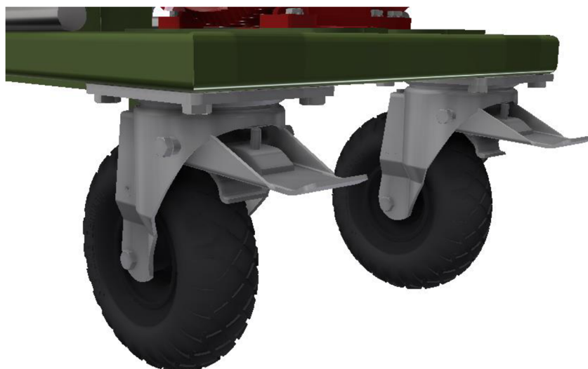
Obr. 33 Přední kolečka přišroubovaná k rámu stroje
