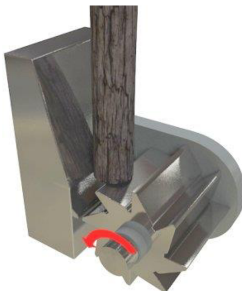
Obr. 4 Způsob drcení se zubovou hlavou [4]
