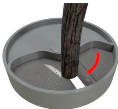
Obr. 3 Způsob drcení nožovou hlavou [4]
