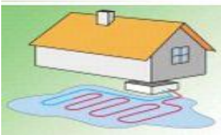
Obr. 8: Kolektor v povrchové vodě.
