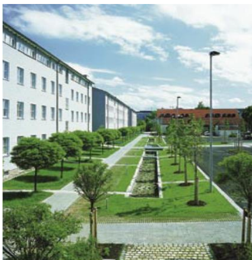
Obrázek 14: Alejová výsadba stromů s integrovanou retencí a vsakováním dešťové vody. (Přírodě blízké odvodnění dopravních ploch v sídlech)
