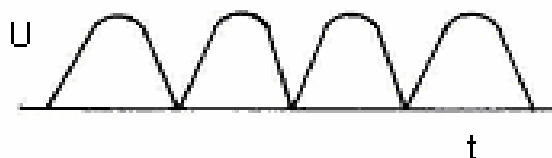
Obrázek 10. Dvoucestně usměrněný střídavý proud.
