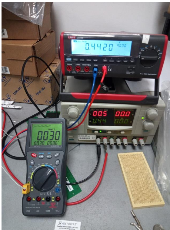
Obrázek 7: Zapojení měřících přístrojů pro měření oteplení rezistoru
