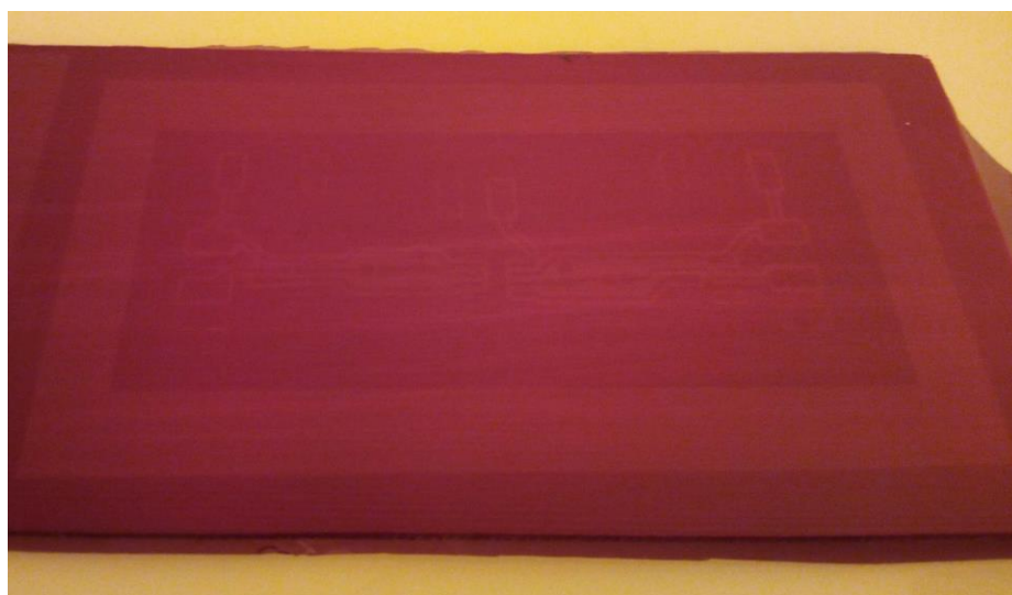
Obrázek 18: Expozice fotorezistu nalaminovaného na DPS
