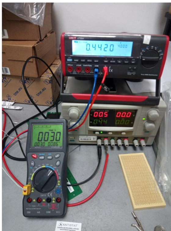
Obrázek 7: Zapojení měřicích přístrojů pro měření oteplení rezistoru
