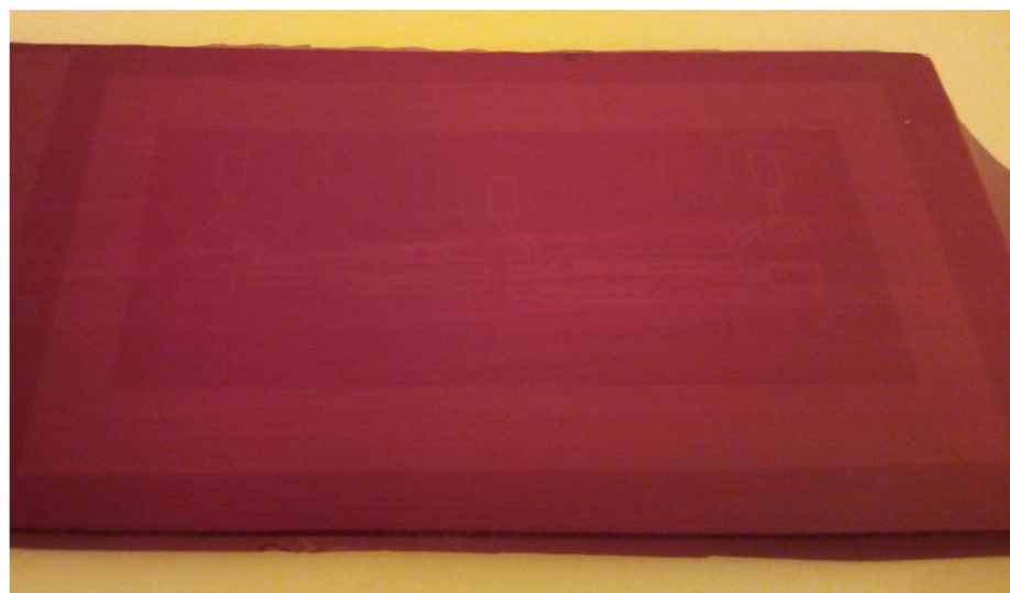
Obrázek 18: Expozice fotorezistu nalaminovaného na DPS
