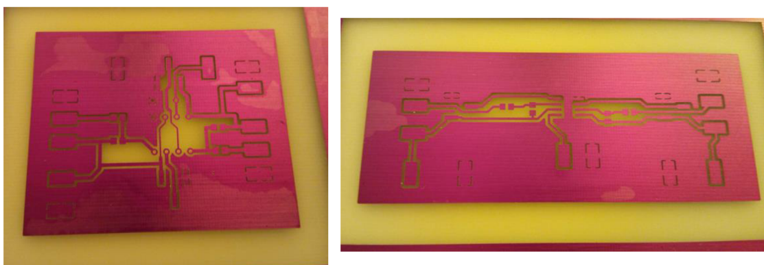
Obrázek 19: Odleptání mědi u DPS (vlevo pro zesilovač LM272M, vpravo pro AD8629ARZ)
