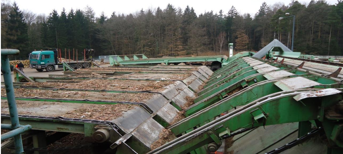
Obrázek 4: Příčný dopravník manipulační linky.
