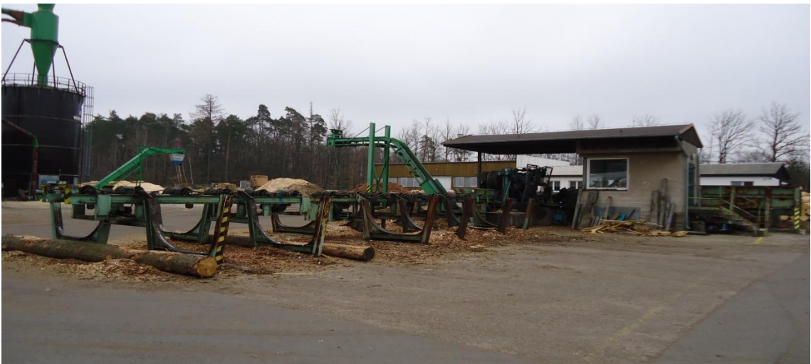
Obrázek 6: Odkorňovač s podélným dopravníkem
