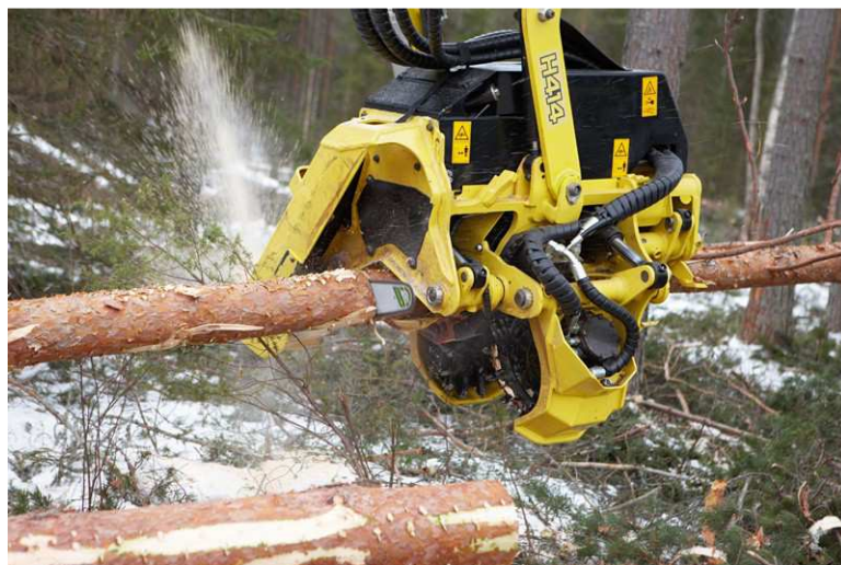
Obr. 5: Harvestorová hlavice při zpracovávání kmene BO ( www.merimex.cz , 22. 3. 2015).
