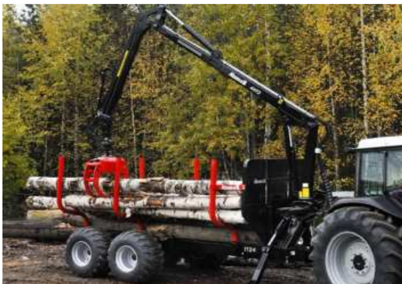
Obr. 7: Vyvážecí souprava (www.stsprachatice.cz, 22. 3. 2015).
