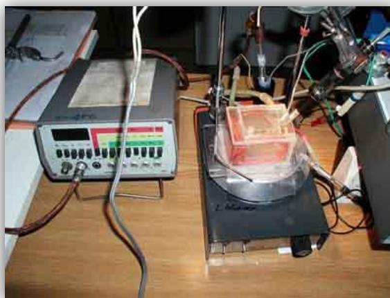
Obrázek 12: Souprava pro měření akčních potenciálů na tentakulích rodu Drosera (fotografie Lubomír Adamec 2006)
