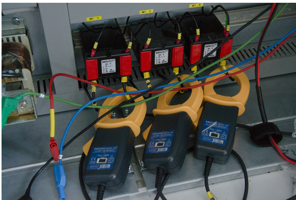
Obr. 4.3: Připojení proudových snímačů IAC
