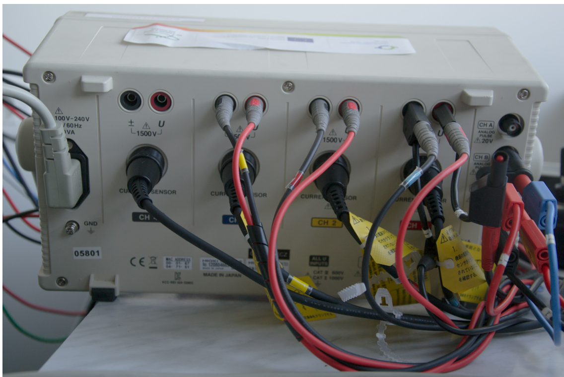
Obr. 3.8: Připojení měřících vodičů
