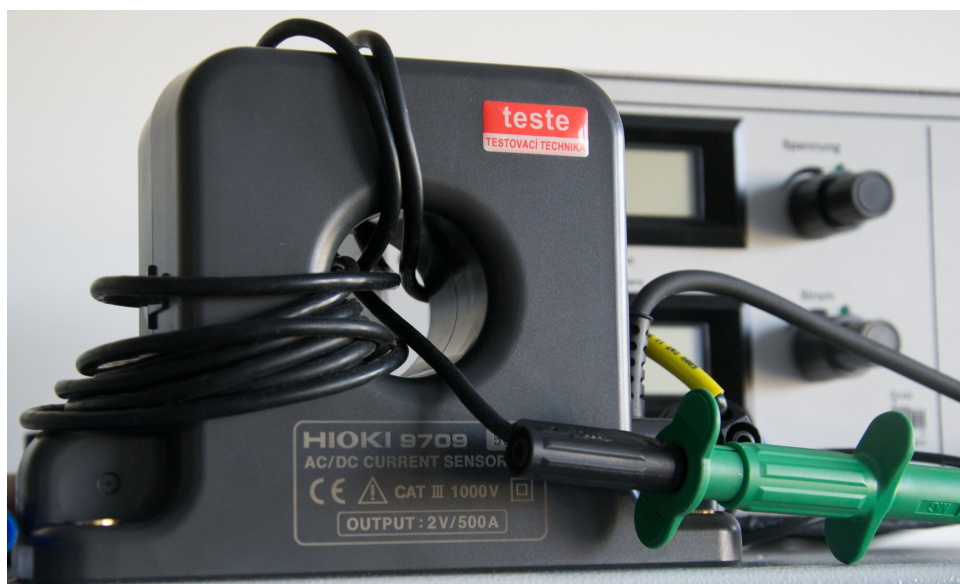
Obr. 4.4: Připojení proudového snímače IDC
