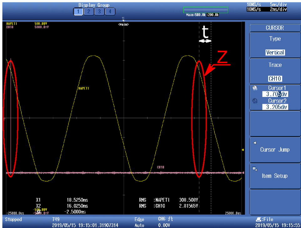
Obr. 3.13: Ilustrační snímek z osciloskopu zachycující signál Z a průběh svorkového napětí
