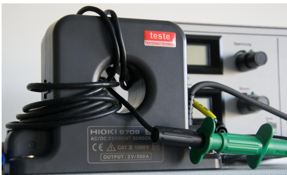
Obr. 4.4: Připojení proudového snímače IDC
