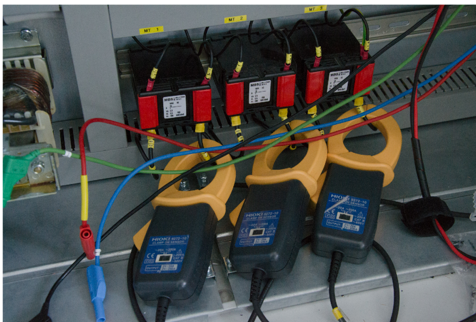
Obr. 4.3: Připojení proudových snímačů IAC
