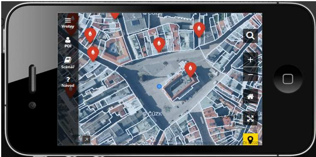
Obrázek 65: Emulace zobrazení na mobilním zařízení, modrý bod uprostřed lokalizuje aktuální pozici uživatele v terénu na základě GPS/IP adresy
