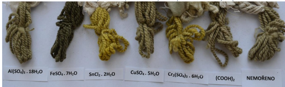
Příloha 2e: Vlněná vlákna barvena listy z ořešáku, dolní část byla zakryta a horní část byla vystavena slunci
