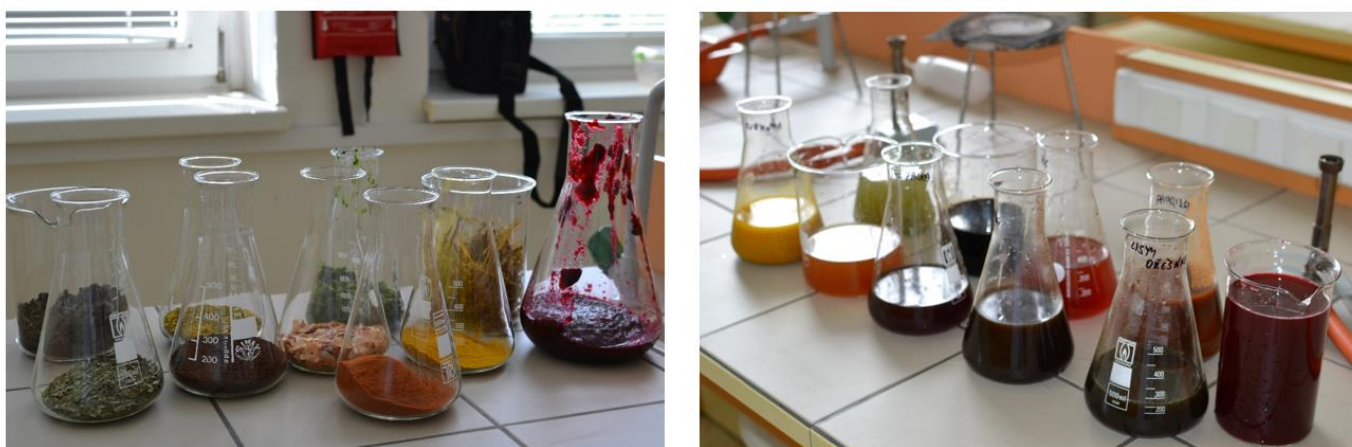
Obrázek 3: Upravené a navážené rostlinné materiály, následně přefiltrovány a připraveny k barvení
