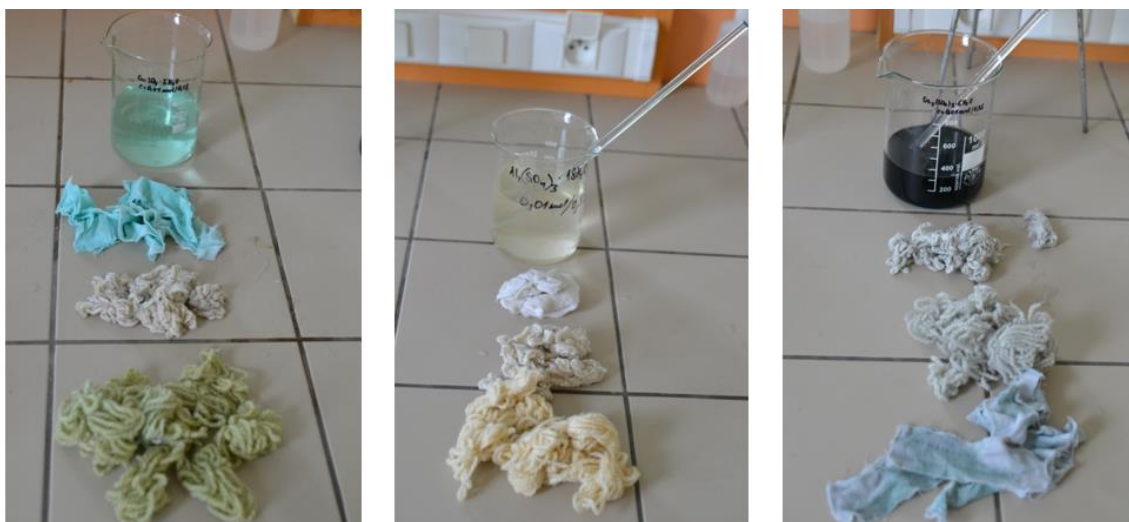
Obrázek 2: Roztoky mořidel a namožené textilní materiály
