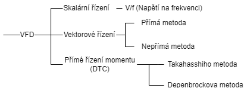
Obr. 26 Schéma rozdělení metod řízení motorů.
