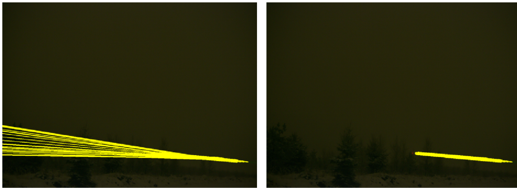
Obr. 5.10: Rozdiel v použití štandardnej Houghovej transformácie (obr. vľavo) a pravdepodobnostnej Houghovej transformácie (obr. vpravo) v skutočnom obraze.
