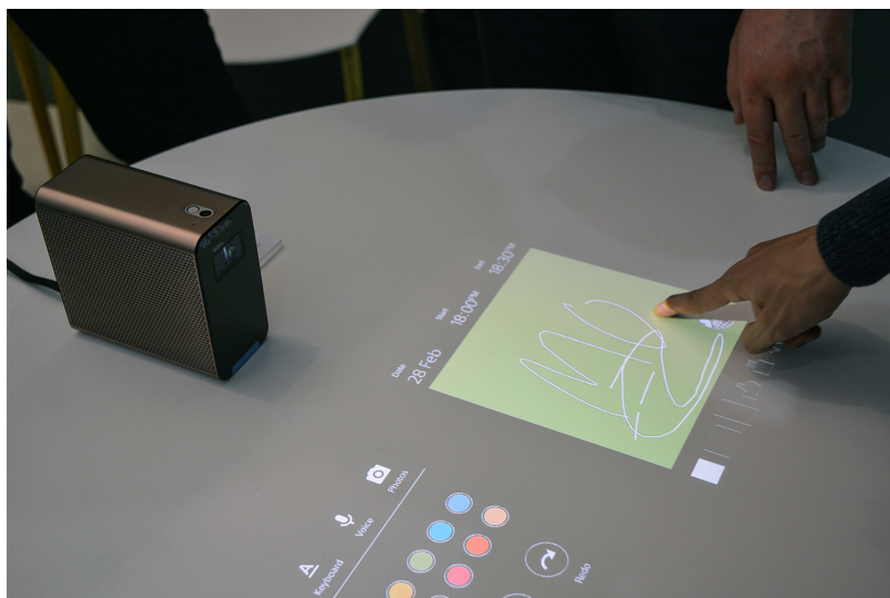
Obrázek 2.11: Sony Xperia Touch, zařízení s operačním systémem Android které přemění obyčejný stůl v interaktivní. Zdroj: [5]
