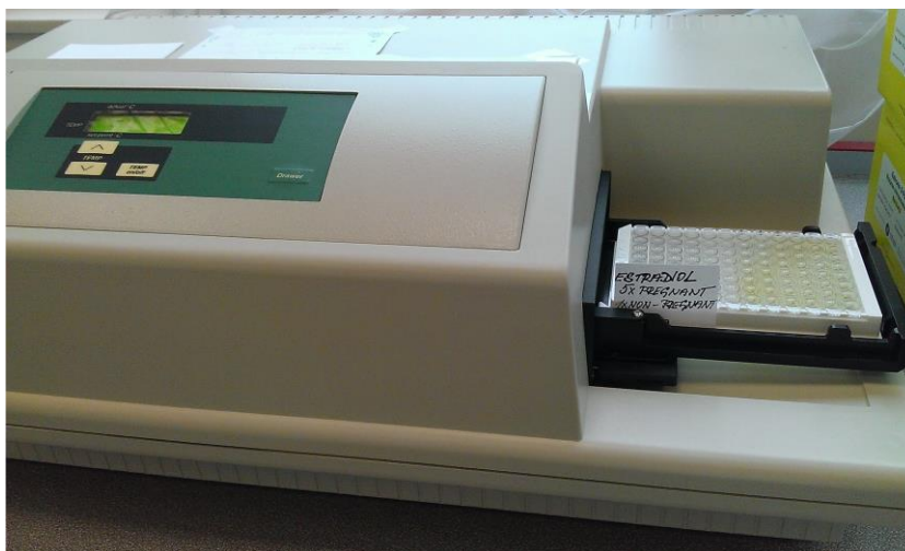
Obrázek 16: Vyhodnocení analýzy spektrofotometrem (VersaMax ELISA reader, Molecular Devices, USA) při vlnové délce \lambda = 450 \text{ nm} , foto: Autorka
