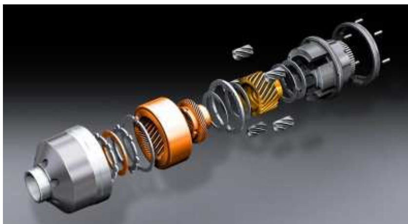
Obr. 26: Rozložený diferenciál Torsen typ C [21]
