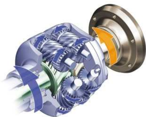
Obr. 19: Mezinápravový diferenciál Torsen u VW Phaeton [17]
