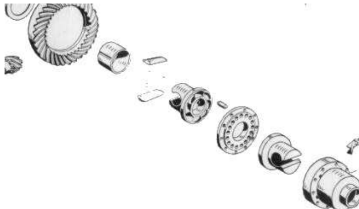
Obr. 29: Rozložený kolíčekový diferenciál [24]
