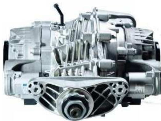
Obr. 43: Dynamický diferenciál DPC použitý ve vozidle BMW X5 [38]
