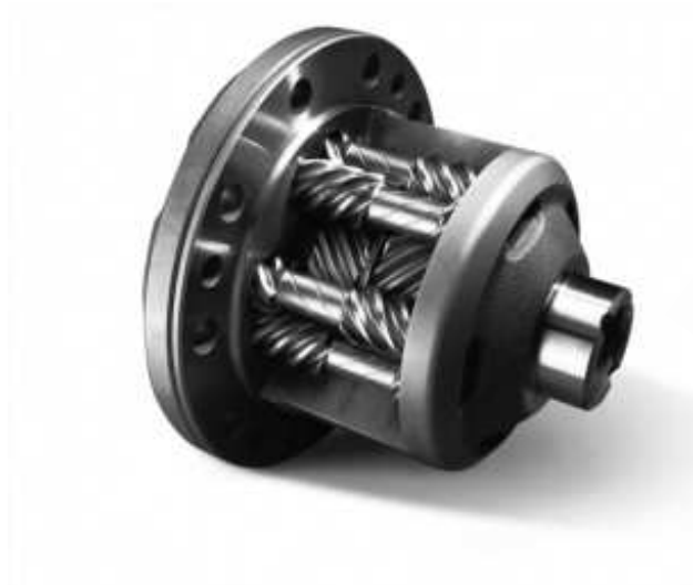
Obr. 21: Torsen typ B z vozu Hyundai Genesis Coupe [18]
