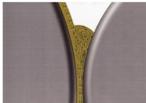
Obrázek 4 Znáznornění pohybu hmoty v pracovním prostoru Twin–roll mixeru při vysoko–smykovém zpracování [47]
