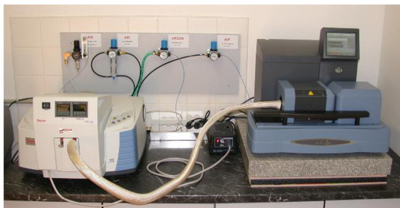
Obrázek 28 SDT Q600 (vpravo) a FT-IR analyzátořem Nicollet iS10 (vlevo)
