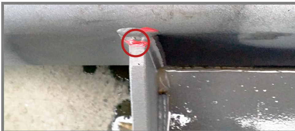
Obr. 2.18 Barvení kritických míst při defektoskopii [1]
