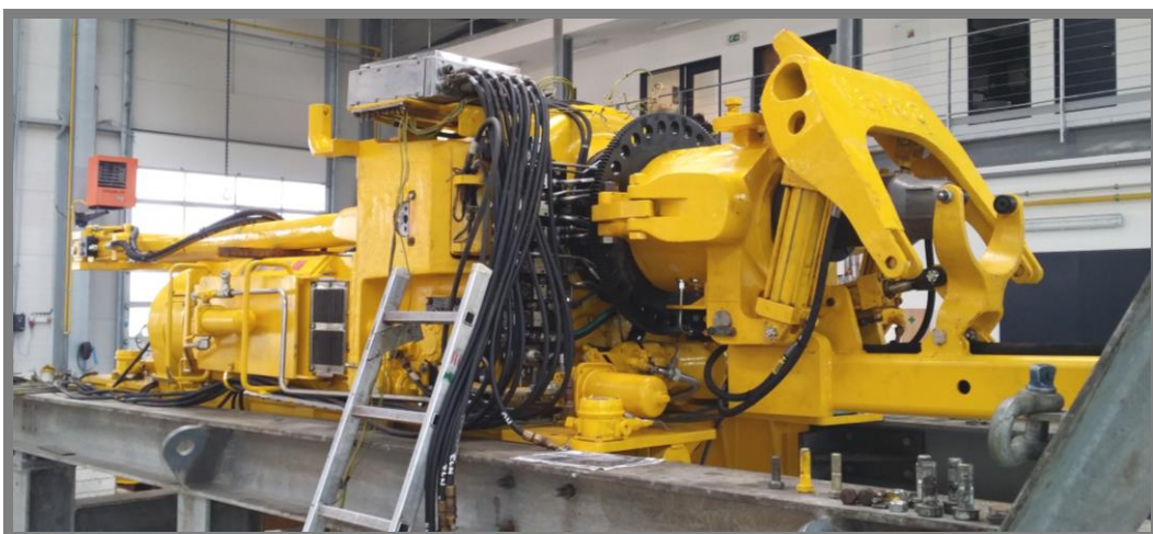
Obr. 2.12 Demontáž nosiče z rotační hlavy [1]
