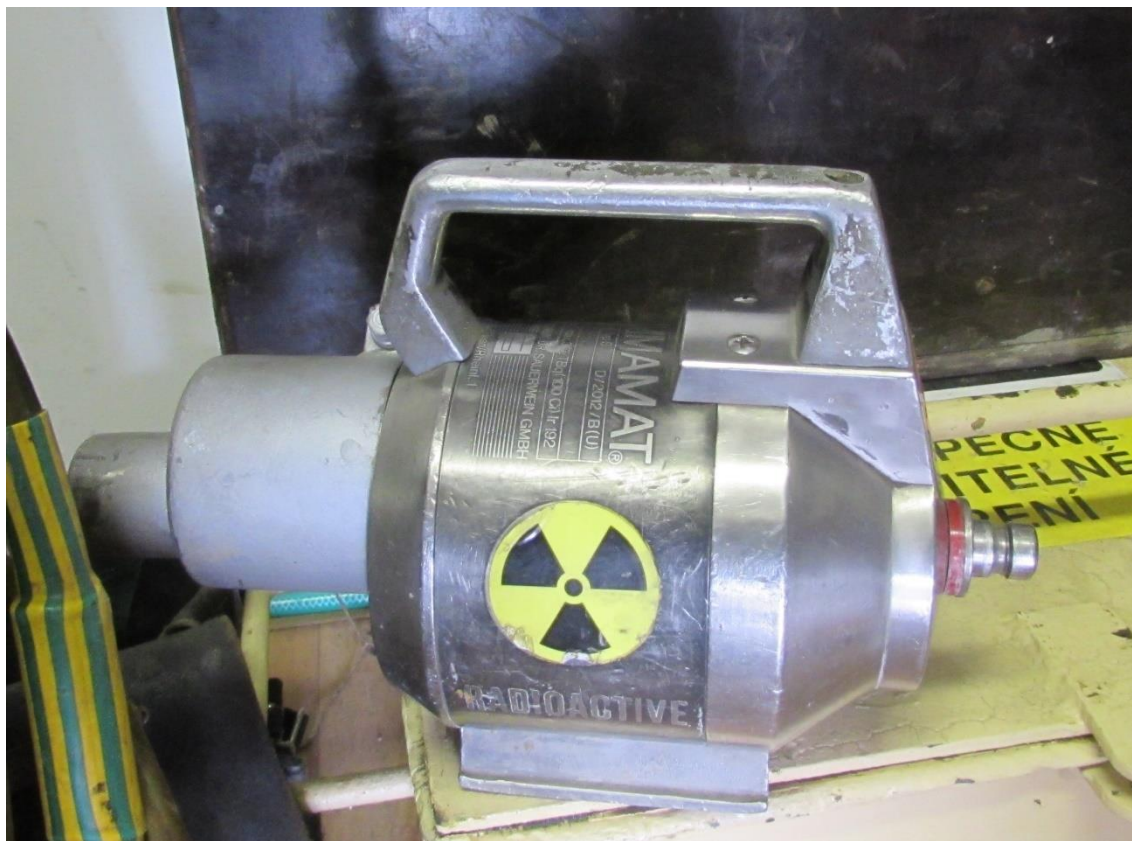
Obrázek 12 zdroj záření gama Foto F. Lukášek
