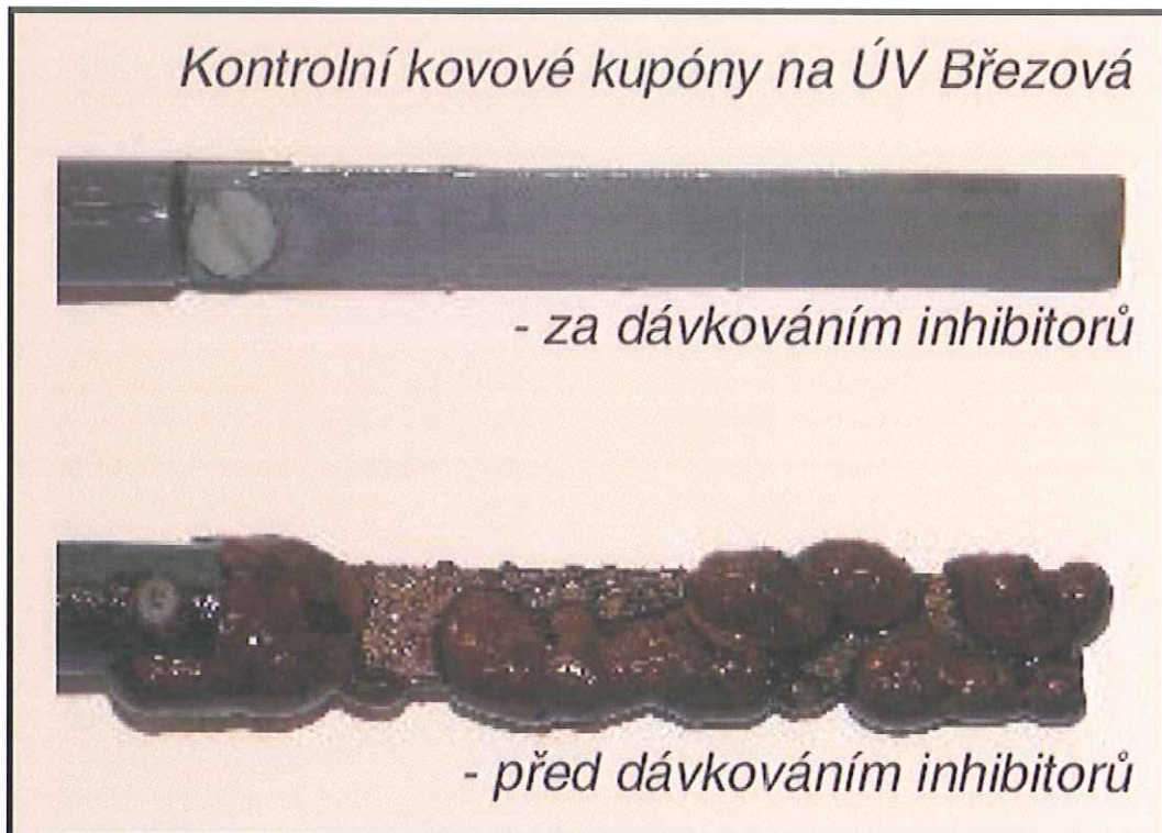
Obr. 8 - Kontrolní kupony pro ověření účinnosti dávkování inhibitorů
