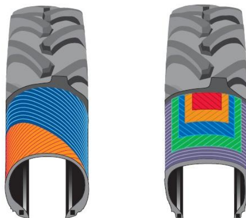
Obrázek 3 Diagonální a radiální pneumatika [8]
