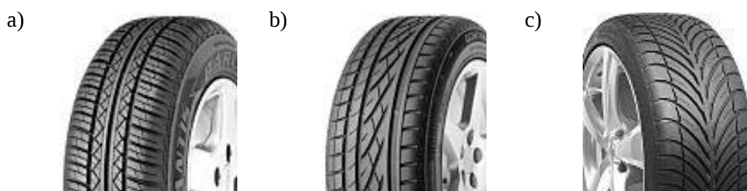
Obrázek 5 Druhy dezénů: a) Symetrický, b) Asymetrický, c) Směrový
