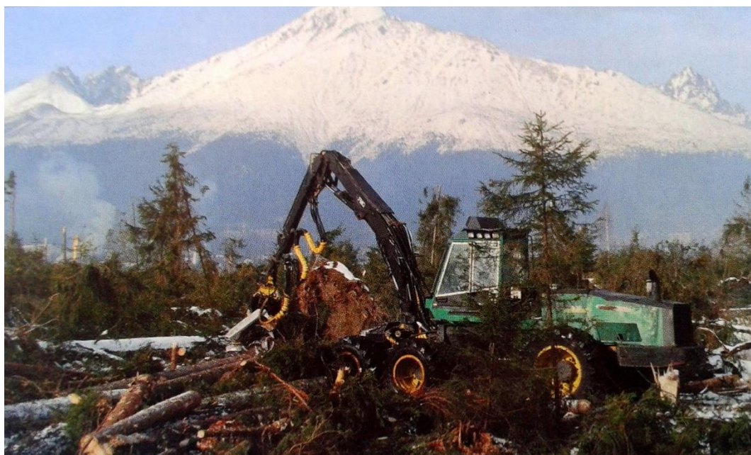
Obr. č. 4 Práca harvestoru na lokalite (Stavný, 2005)
