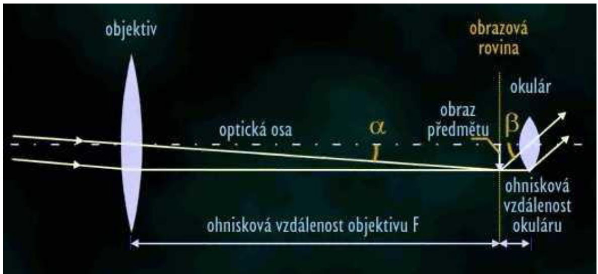
Obrázek 6 Princip dalekohledu (www.veronika.sovova.sweb.cz)
