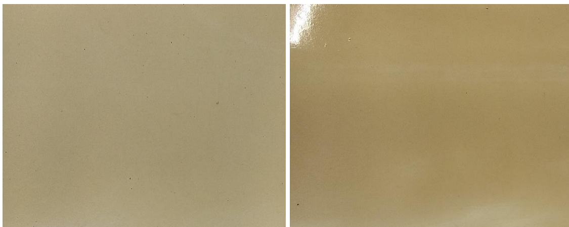
Obr. 3.3.6 Povrch kompozitních fólií: PLLA/1Km (vlevo), PLLA/PLLA-g-MAH(5)/1Km (vpravo)
