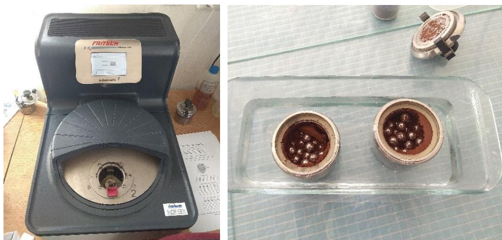
Obr. 3.2.2 Planetový mlýnek (vlevo), misky s kávovou sedlinou a ocelovými kuličkami (vpravo)
