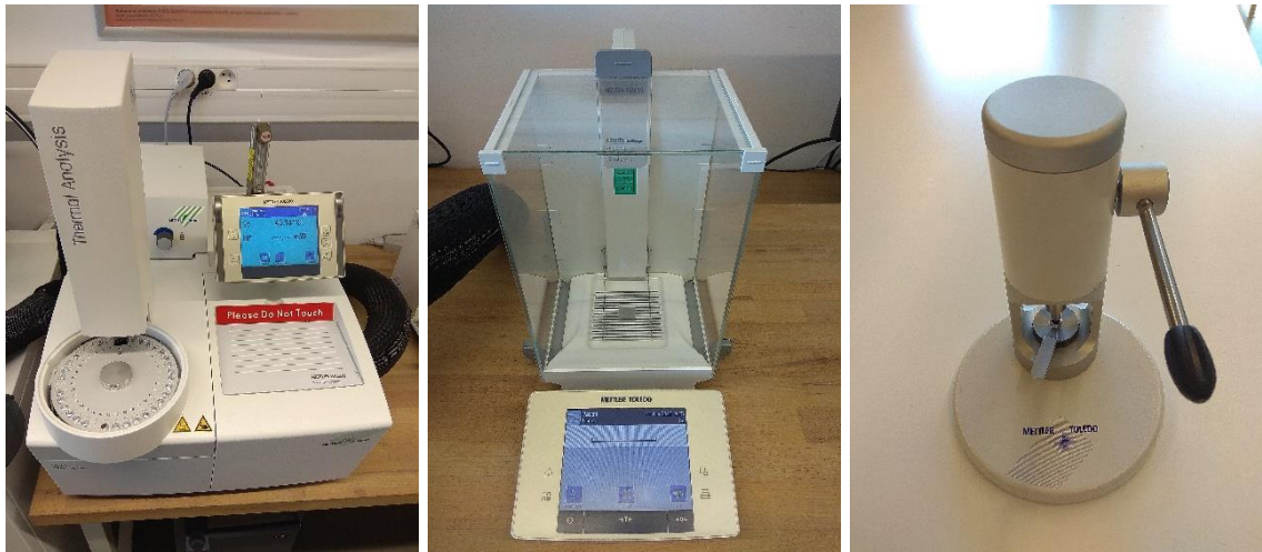
Obr. 3.4.3 Zleva diferenční snímací kalorimetr Mettler Toledo DSC1/700, váha Mettler Toledo XSE 105 Dual Range a ruční lis Mettler Toledo
