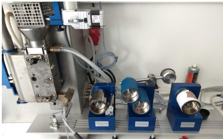
Obr. 3.3.3 Vytlačovací hlava a následný navíjecí systém
