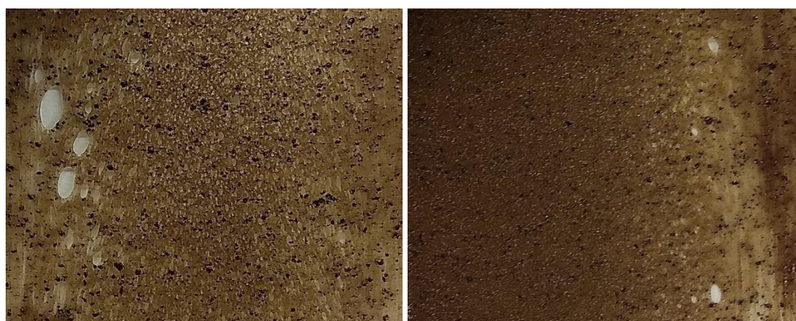
Obr. 3.3.7 Povrch kompozitních fólií: PLLA/10Kp (vlevo), PLLA/PLLA-g-MAH(5)/10Kp (vpravo)
