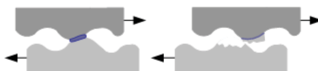
Obr. 10 Princip adhezního opotřebení [39]
