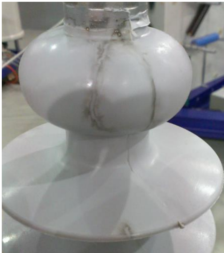
Obrázok 15: Stav izolátoru po testovaní
