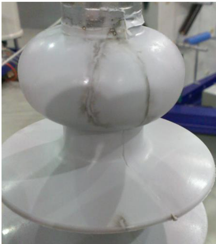
Obrázok 15: Stav izolátoru po testovaní
