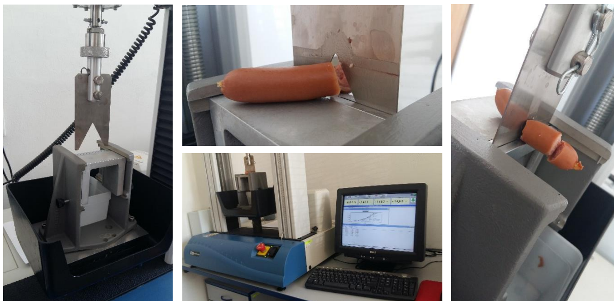
Obrázek 8 - Měření stříhu na Instronu s pomocí Warner-Bratzlerova nože
