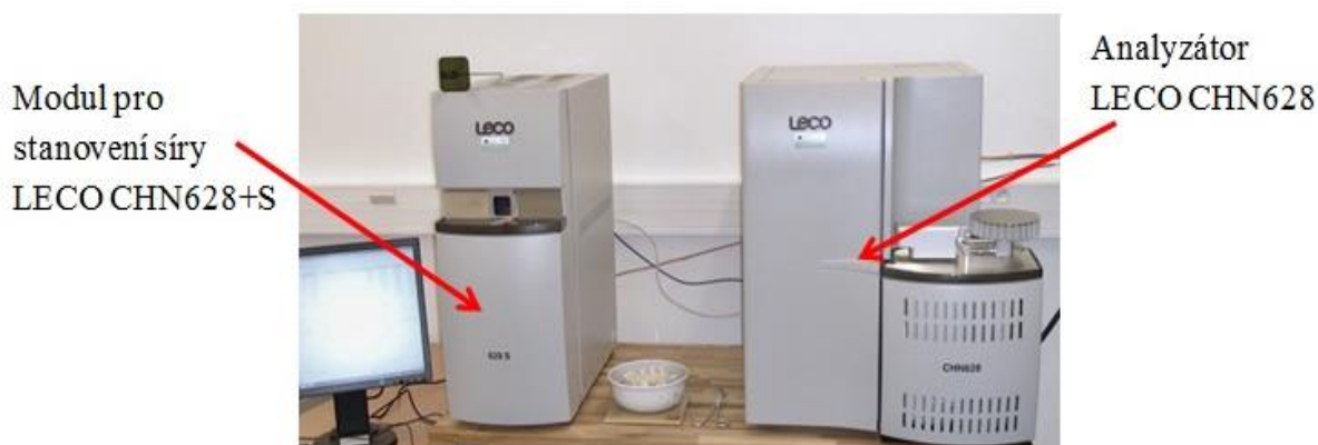
Obrázek 21. Analyzátor LECO CHN628+S (zleva), Analyzátor LECO CHN628 (foto autorka)
