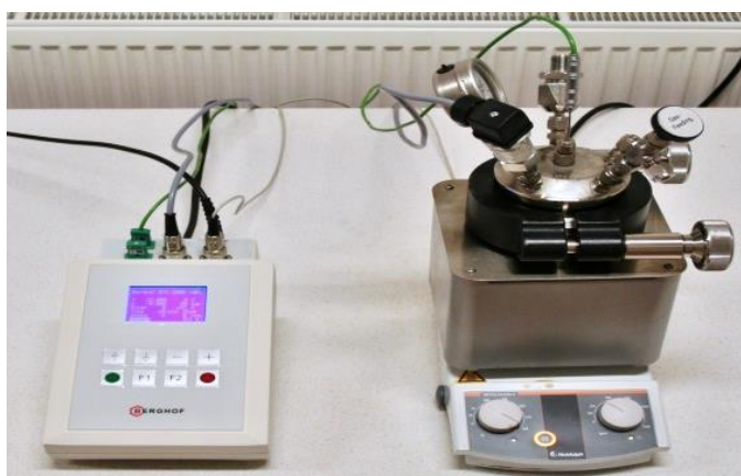
Obrázek 20. Reaktor Berghof s regulátorem BTC3000 (foto autorka)
