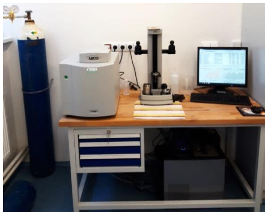
Obrázek 24. Kalorimetr LECO AC-600 (foto autorka)
