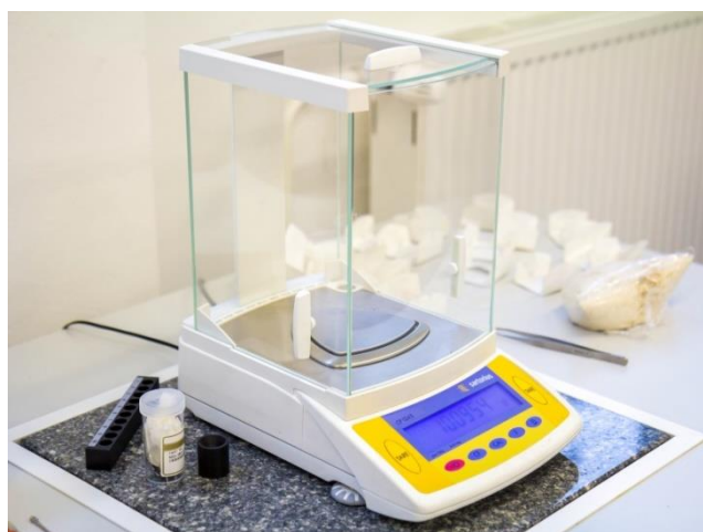
Obrázek 10. Laboratorní váha Sartorius SP124 S (foto autorka)
