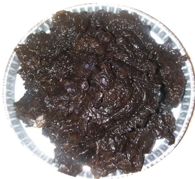
Obrázek 46. Výsledný biouhel čerstvého odpadu bílého hlávkového zelí po hydrotermální karbonizaci při teplotě procesu 180 °C, době procesu 30 minut (průměr tácku 10 cm) (foto autorka)
