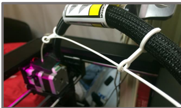
Obr. 22 Vedení pomocí vodicích otvorů [18]
