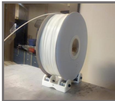
Obr. 19 Přímé uložení na ložiscích [10]
