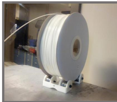
Obr. 19 Přímé uložení na ložiscích [10]
