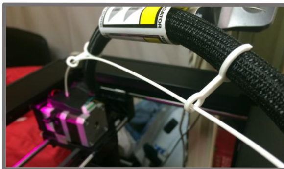
Obr. 22 Vedení pomocí vodicích otvorů [18]
