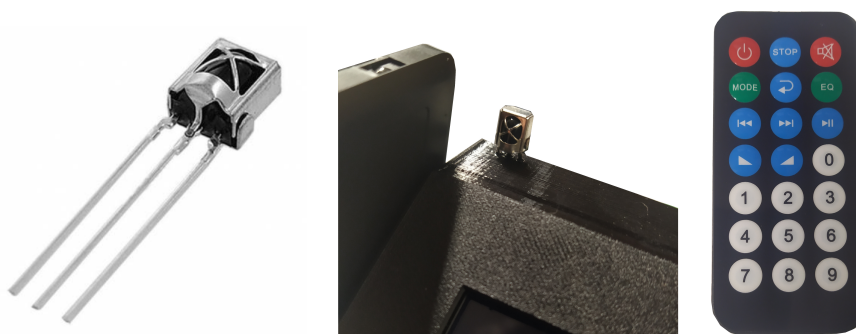
Obr. 2.2: IR systém dálkového ovládání
