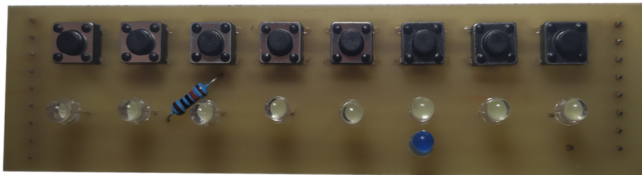
Obr. 2.8: Osazená DPS pro ovládací panel
