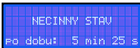
Obr. 3.2: Rozložení zobrazovaných informací na LCD pro nečinný režim řízení
