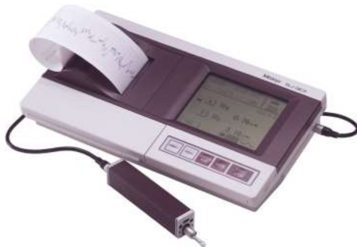
Obr. 3.10 – Přístroj na měření drsnosti povrchu Mitutoyo SJ-301 [24].
