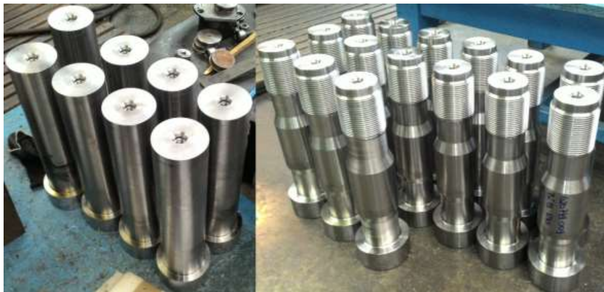
Obr. 3.9 – Stav dodaného polotovaru (vlevo) a stav po obrobení na soustruhu MAS S80i (vpravo).
