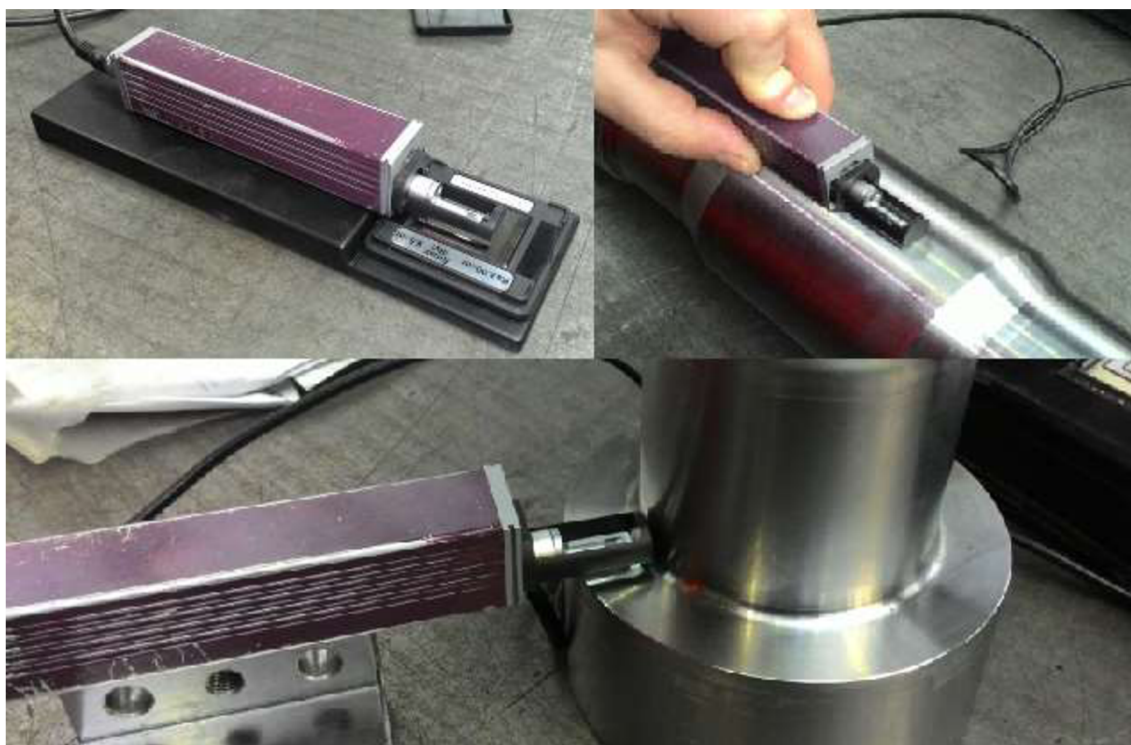
Obr. 3.11 – Měření drsnosti (vlevo nahoře – kalibrace, vpravo nahoře – Plocha č. 3, dole – Plocha č. 4).
