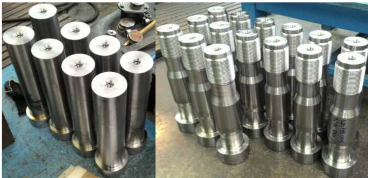
Obr. 3.9 – Stav dodaného polotovaru (vlevo) a stav po obrobení na soustruhu MAS S80i (vpravo).
