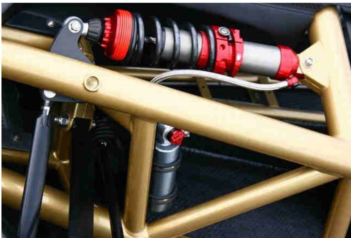
Obr. 16 Ariel Atom 500 V8 Limited Edition – zavěšení kola přední nápravy [14]
