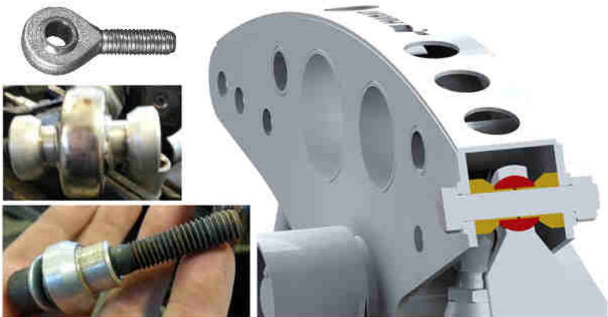
Obr. 27 Uložení tlačné tyče a tlumiče/pružiny ve vahadle
