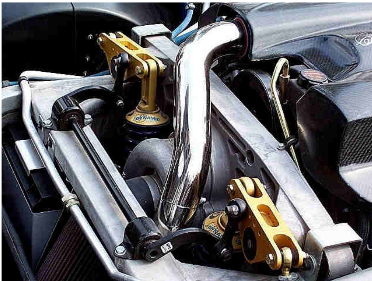
Obr. 21 Shelby Series 1 - detail zavěšení přední nápravy, uložení vahadla [20]
