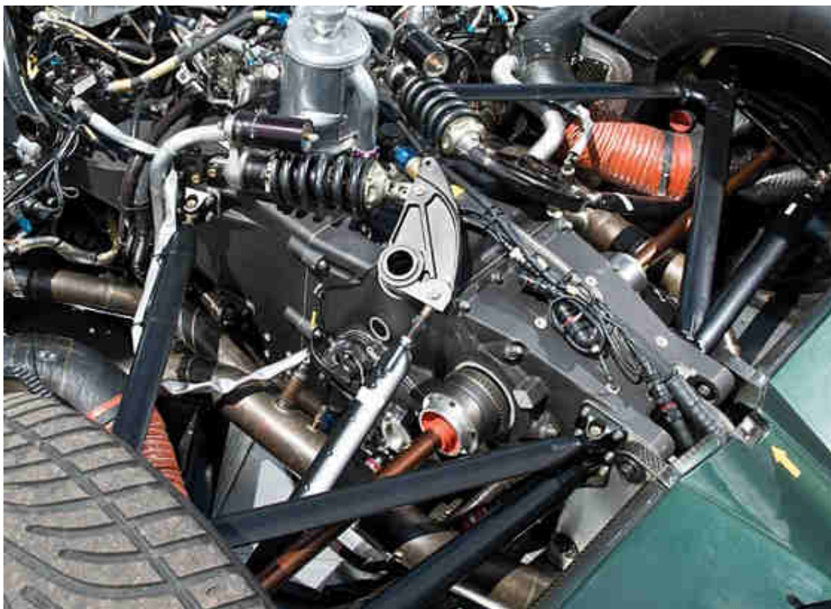
Obr. 11 Bentley Speed 8 – vahadlo odpružení zadní nápravy 83 [10]
