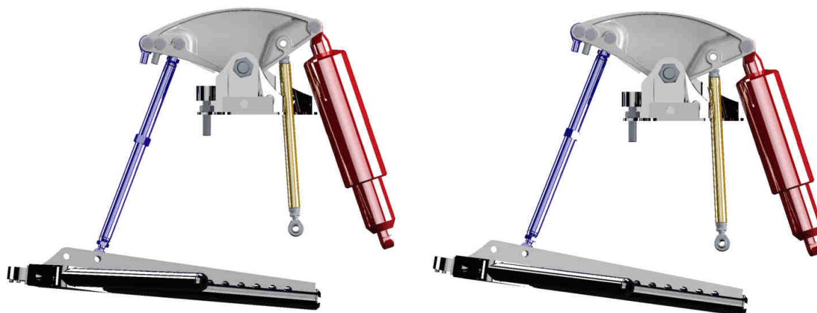
Obr. 90 Rozsah výkyvu vahadla, síla v tlačné tyči vyšší než 20 kN
