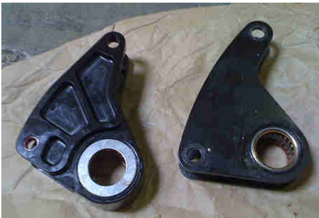
Obr. 17 Ariel Atom - nové vahadlo vlevo, vpravo originální, původní vahadlo [16]
