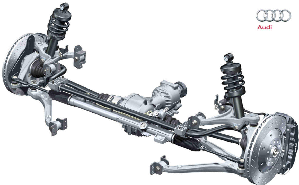
Obr. 4 Lichoběžníková přední poháněná náprava Audi R8 [5]
