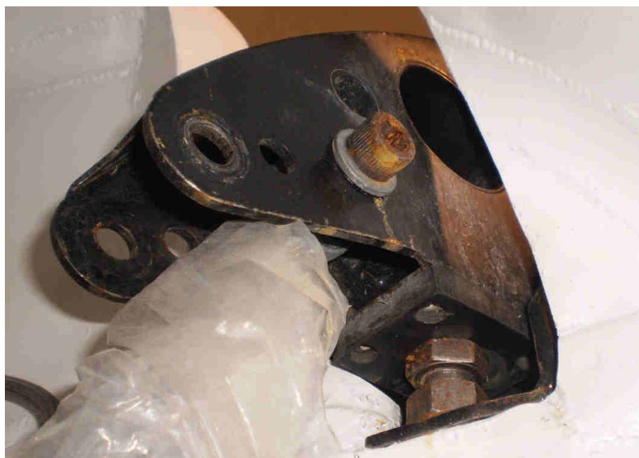
Obr. 25 Doraz vyvěšení kola přinýtovanou pryžovou deskou
