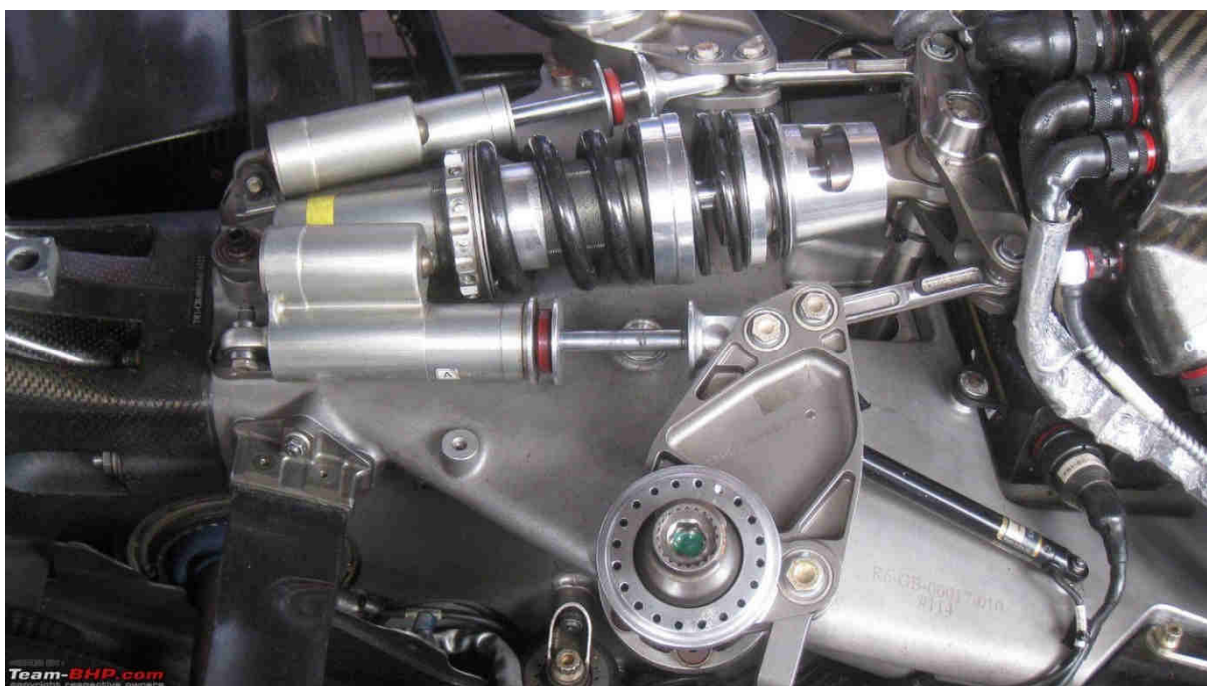
Obr. 10 Red Bull - vahadlo odpružení zadní nápravy F1 [9]
