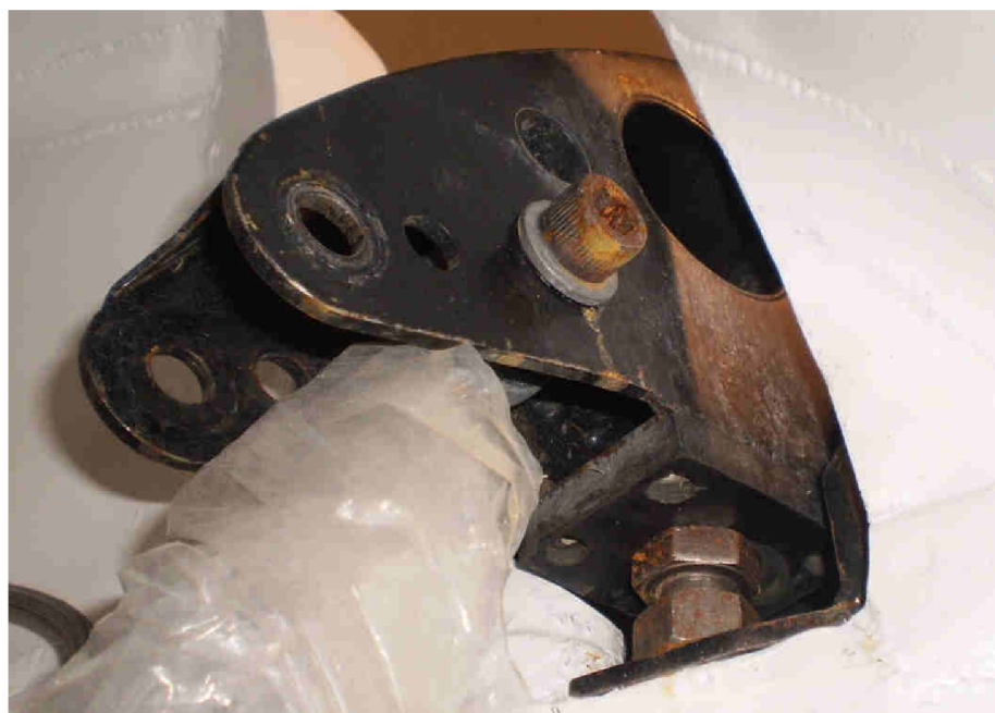
Obr. 25 Doraz vyvěšení kola přinýtovanou pryžovou deskou
