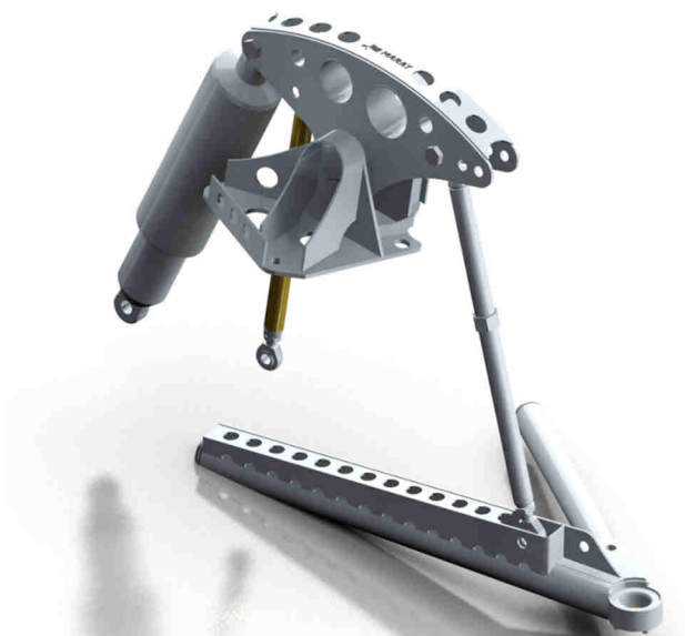
Obr. 22 Model sestavy zavěšení pravého předního kola
