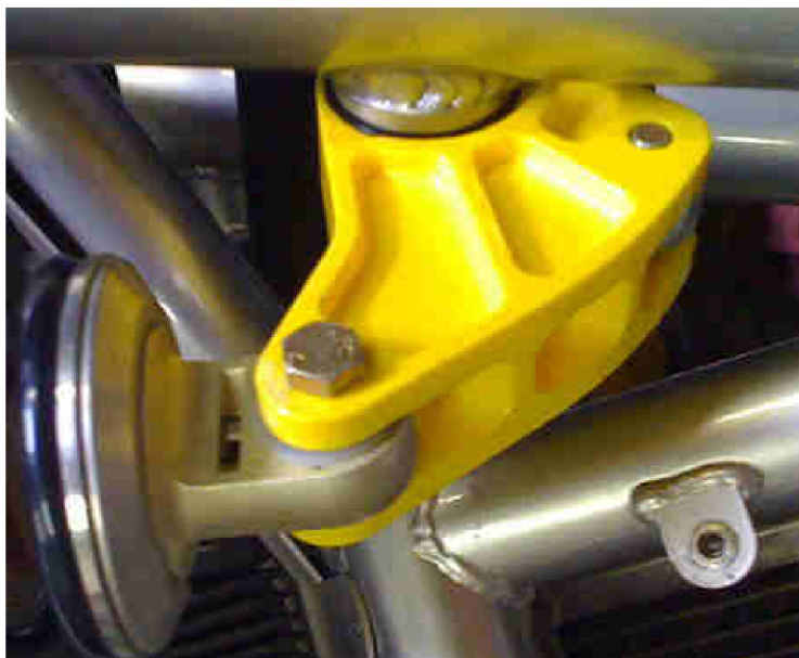
Obr. 18 Ariel Atom - náhrada originálního vahadla plastovým prototypem [16]
