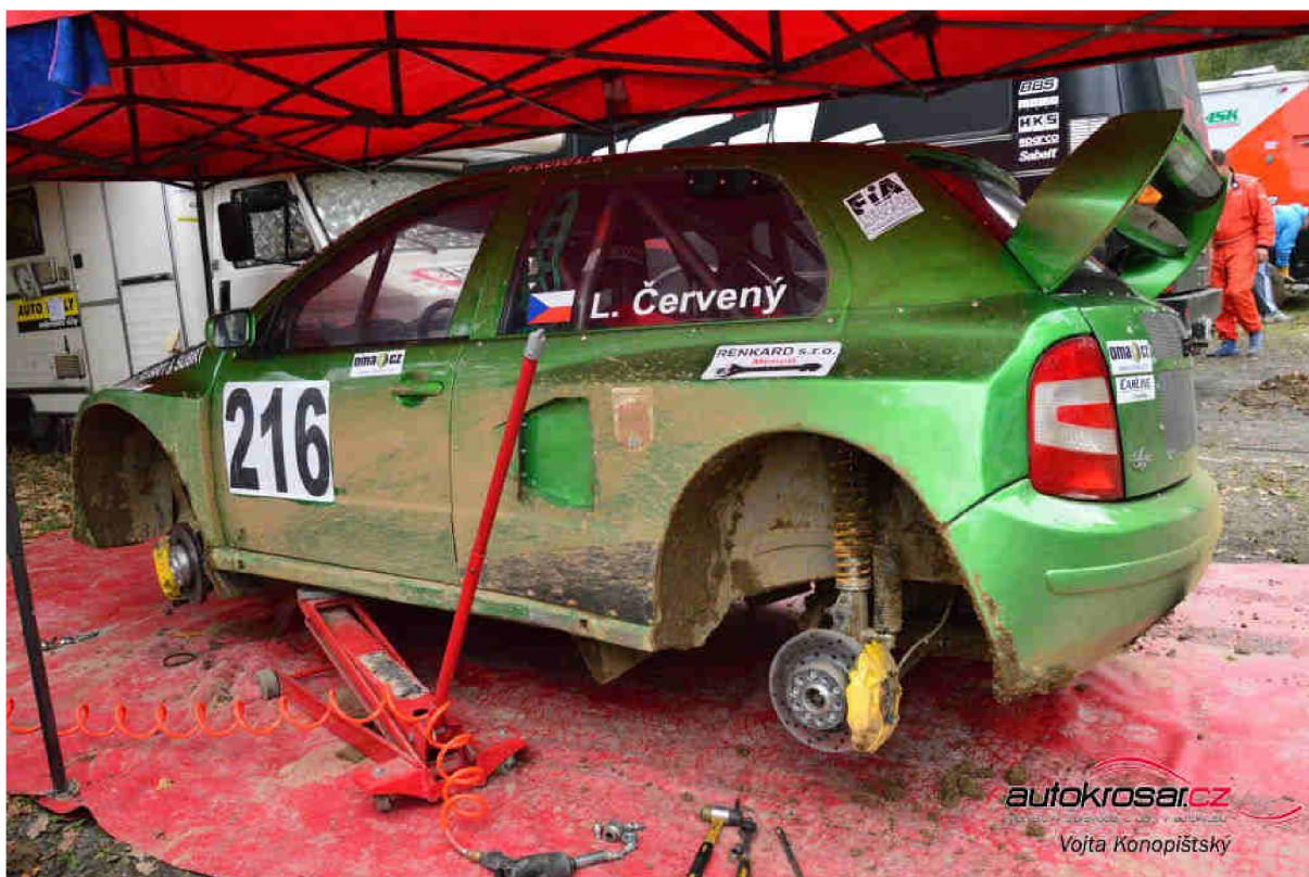
Obr. 3 Pohled na zavěšení MacPherson autokrosového vozidla [6]
