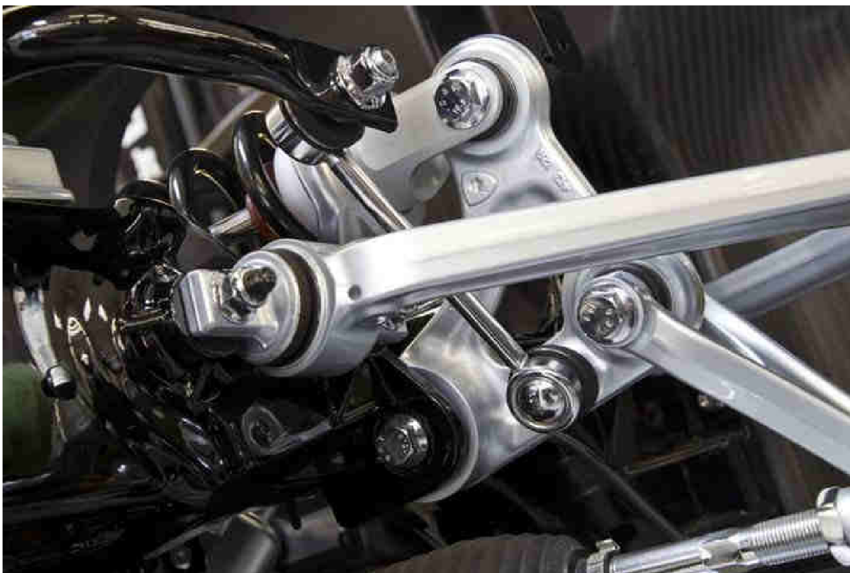
Obr. 13 Lamborghini Aventador LP700-4 – zavěšení kola přední nápravy [11]
