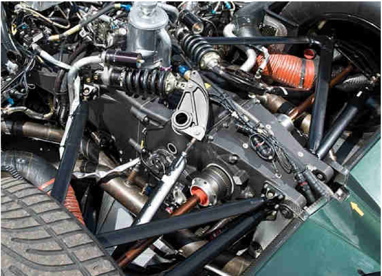
Obr. 11 Bentley Speed 8 – vahadlo odpružení zadní nápravy 83 [10]
