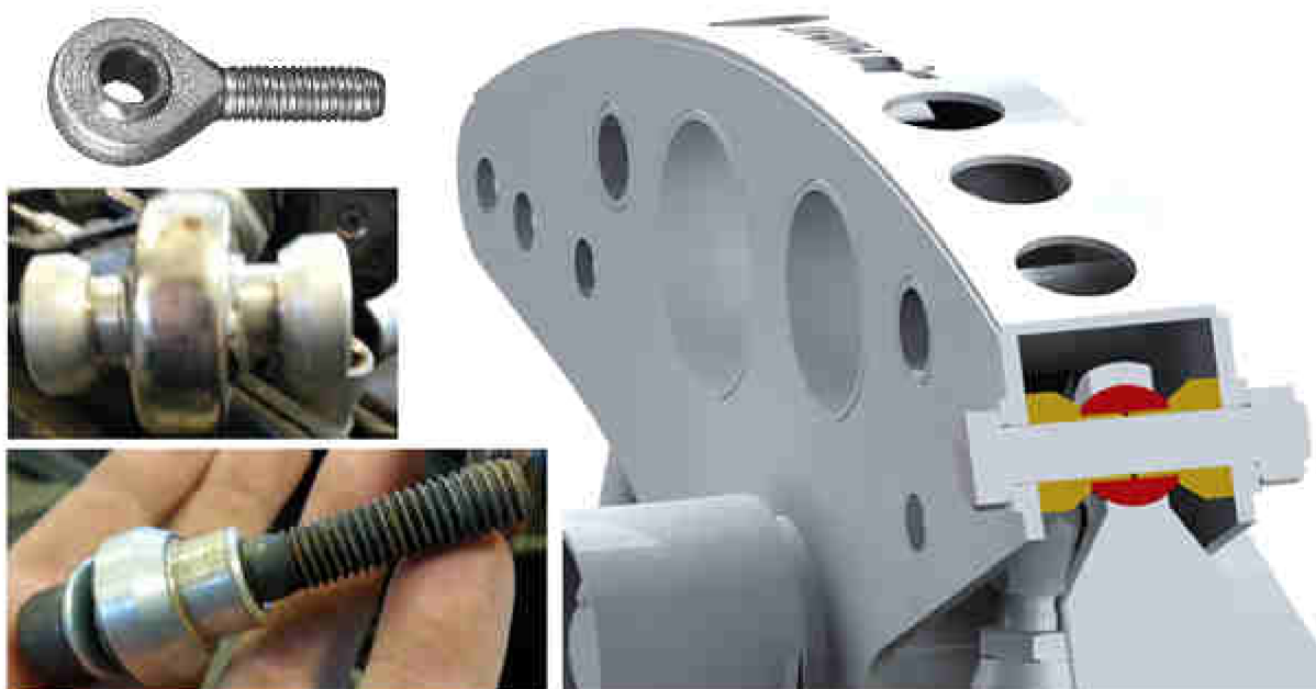
Obr. 27 Uložení tlačné tyče a tlumiče/pružiny ve vahadle
