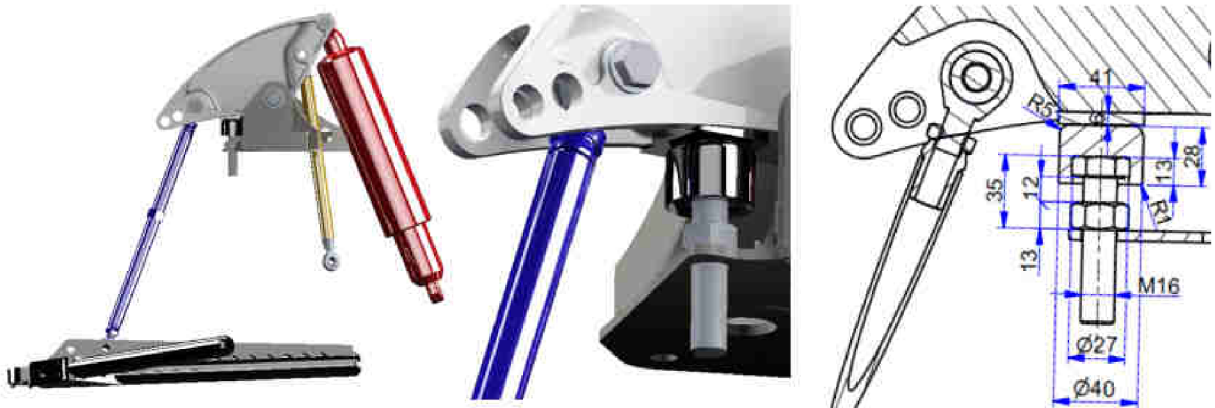
Obr. 91 Konstrukční řešení dolního dorazu
