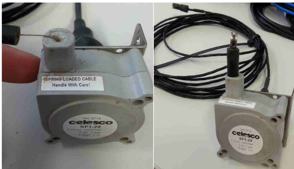
Obr. 30 Snímač s lankovým mechanismem SP1 – 25
