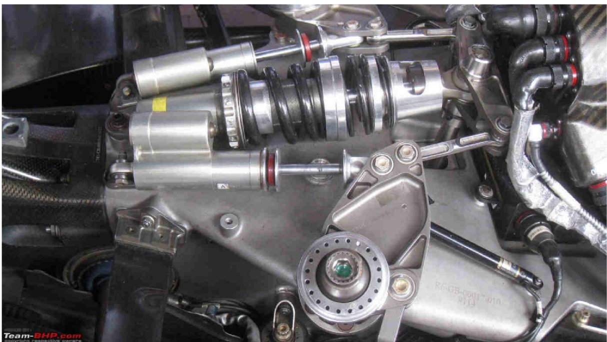
Obr. 10 Red Bull - vahadlo odpružení zadní nápravy F1 [9]
