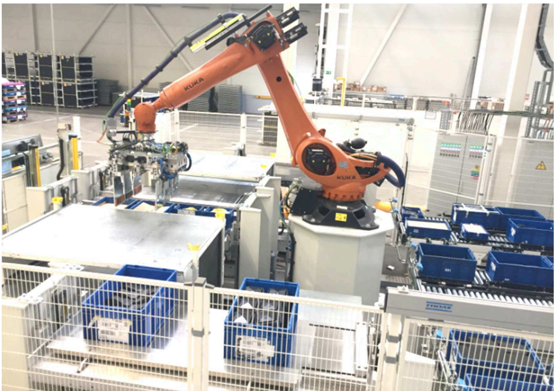
Obr. 2.11 Automatické pracoviště výstupu AKL s robotickým ramenem
