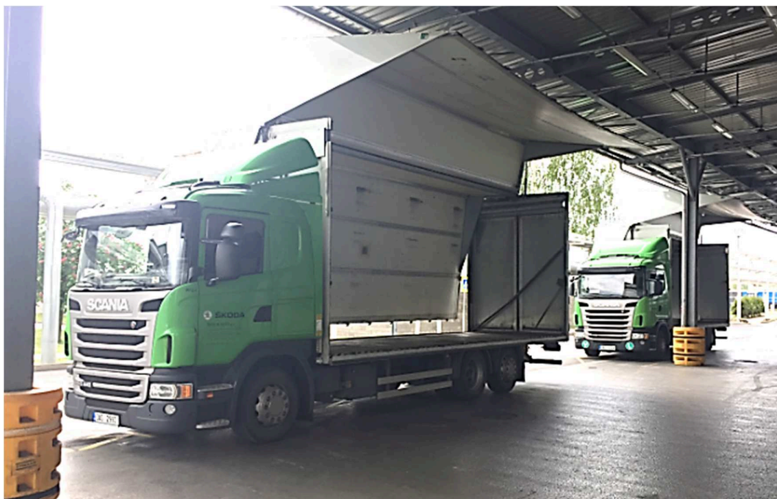
Obr. 2.14 SCANIA G440 s nástavbou Bose – tzv. „krovkami“
