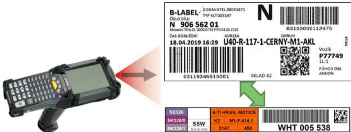
Obr. 3.4 Princip párování iTLS – porovnávání informací ve dvou 1D kódech
