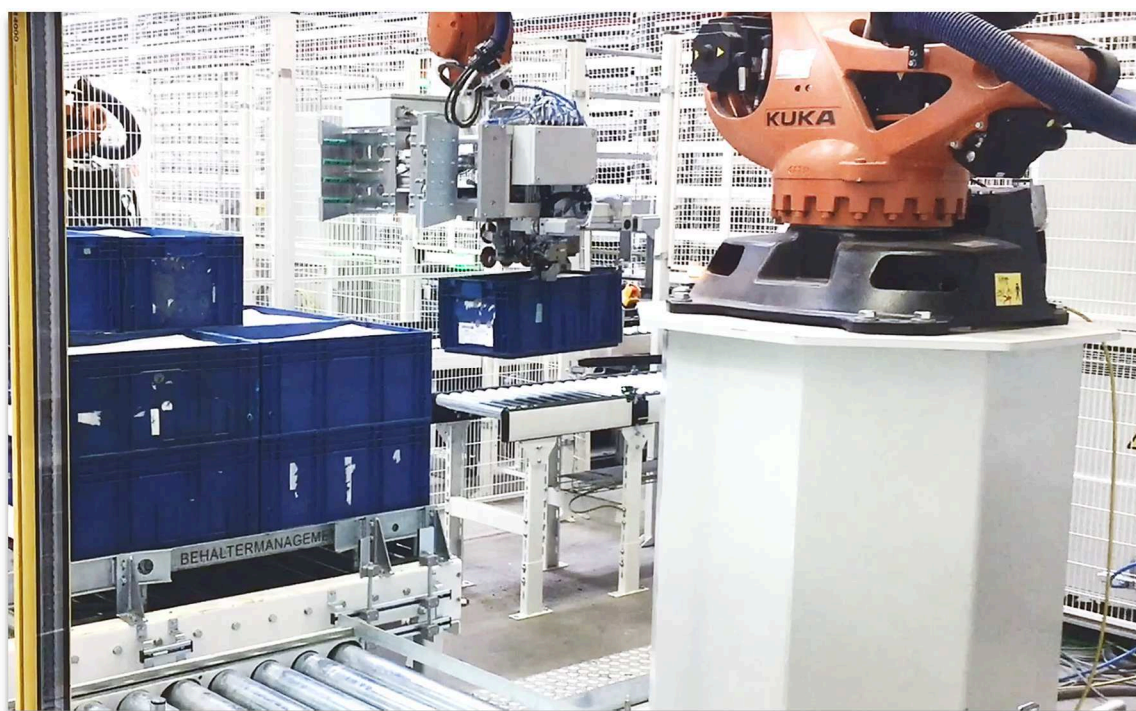
Obr. 2.8 Robotický depaletizér na automatickém pracovišti vstupu AKL
