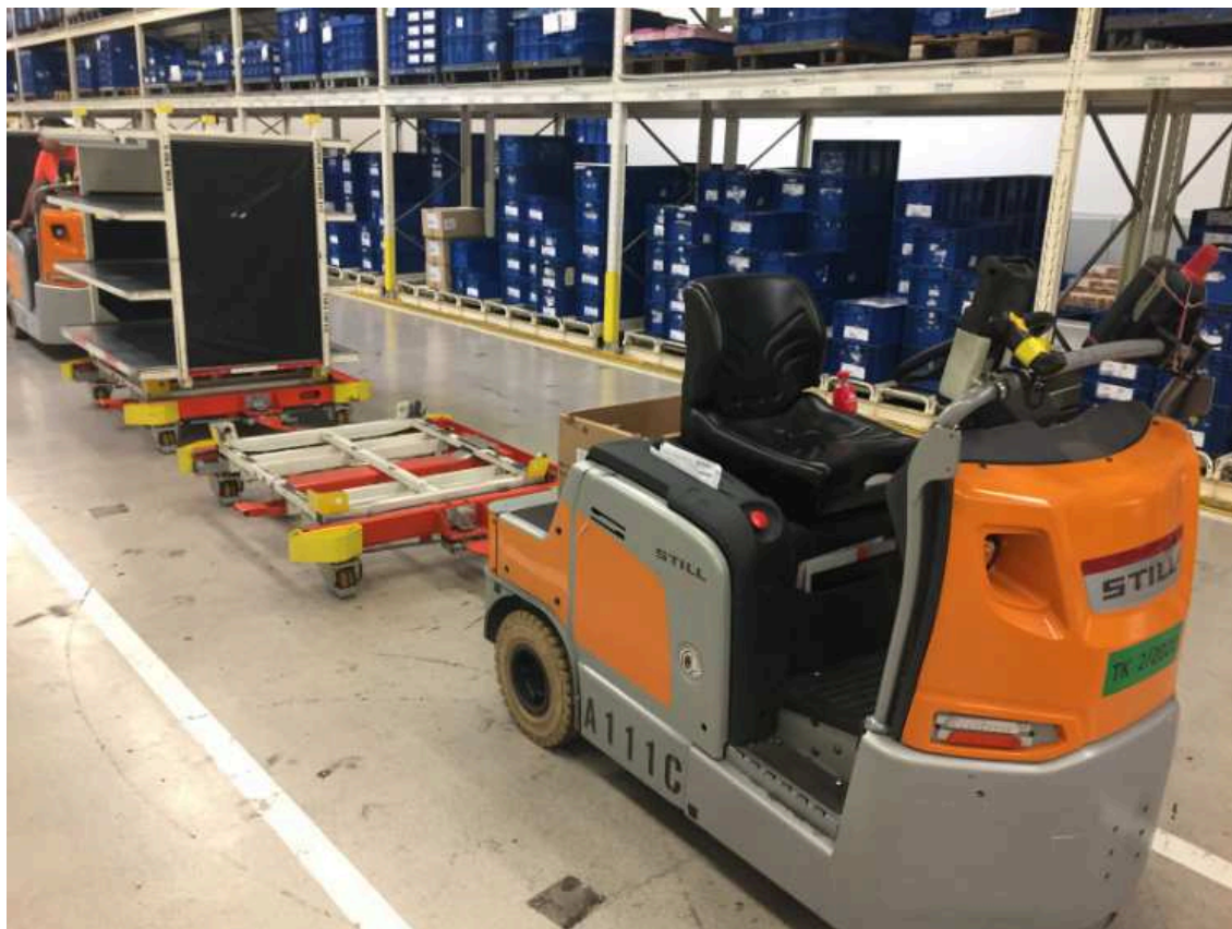
Obr. 2.17 Trajlerová souprava: tahač LTX 70 s připojenými transportními C-rámy
