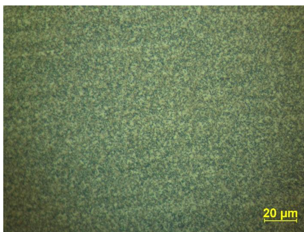
Obr. 3.23 Mikrostruktura pístního kroužku, ocel – Nital, zvětšení 500násobné (10x50), kroužek č. 2
