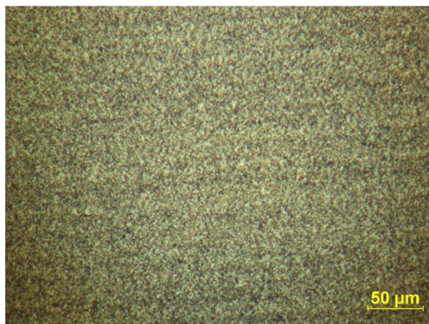
Obr. 3.22 Mikrostruktura pístního kroužku, ocel – Nital, zvětšení 250násobné (20x12.5), kroužek č. 2
