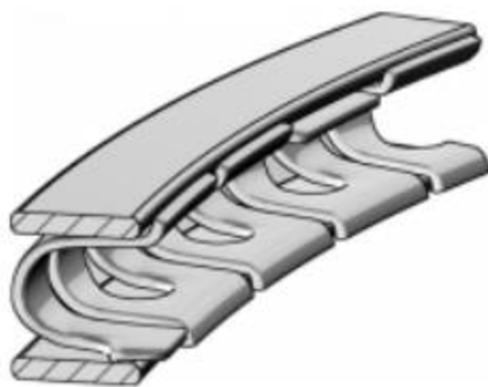
Obr. 2.8 Stírací pístní kroužek skládaný [18]
