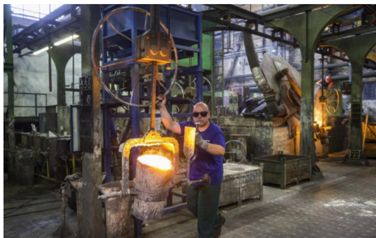
Obr. 3.9 Pohled do tavírny na elektrické indukční pece
