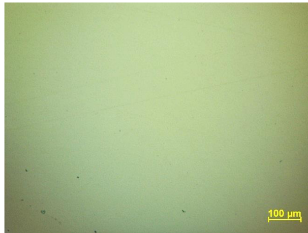
Obr. 3.20 Mikrostruktura pístního kroužku, ocel – neleptáno, zvětšení 100násobné (8x12,5), kroužek č. 2
