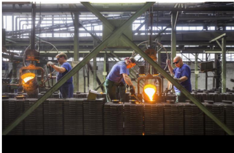
Obr. 3.8 Odlévání etážových forem při odlévání litinových polotovarů pistních kroužků
