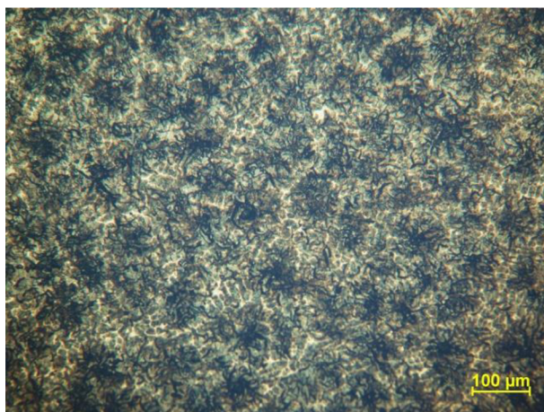
Obr. 3.16 Mikrostruktura pístního kroužku z litiny s lupinkovým grafitem – Nital, zvětšení 100násobné (8x12,5), kroužek č. 1
