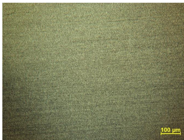
Obr. 3.21 Mikrostruktura pístního kroužku, ocel – Nital, zvětšení 100násobné (8x12,5), kroužek č. 2
