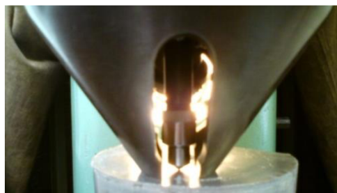
Obr. 3.31 Pohled na vlačovaný indentor do pístitního kroužku při měření tvrdosti podle Vickerse
