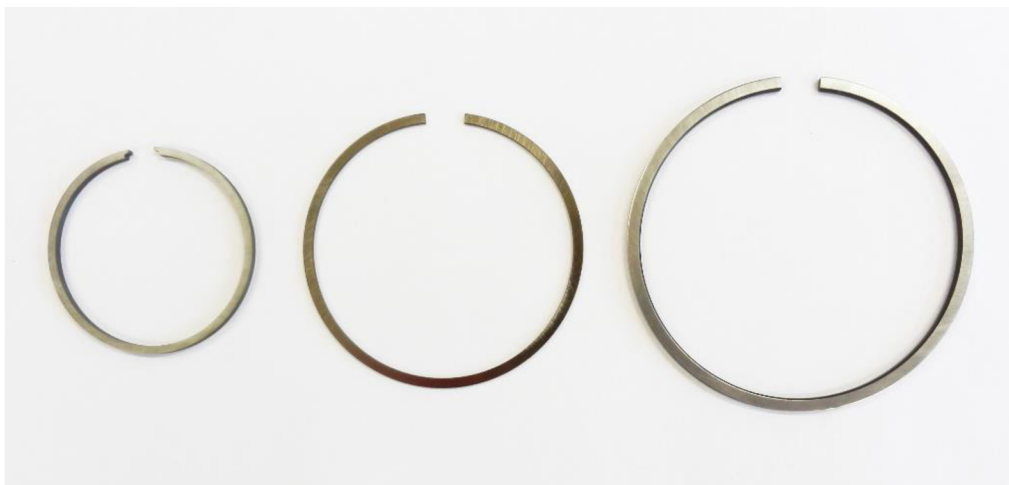
Obr. 3.12 Pístní kroužky, které byly použity při řešení této bakalářské práce (zleva kroužek č.1, kroužek č.2, kroužek č.3)
