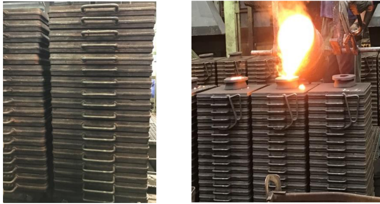
Obr. 3.7 Formy pro etážové liti a odlévání do forem pro etážové liti
