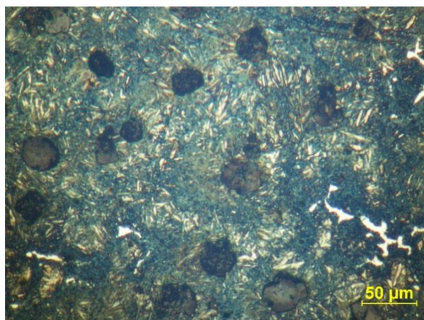
Obr. 3.30 Mikrostruktura pístního kroužku, litina s kuličkovým grafitem – Nital, zvětšení 250násobné (20x12.5), kroužek č. 3
