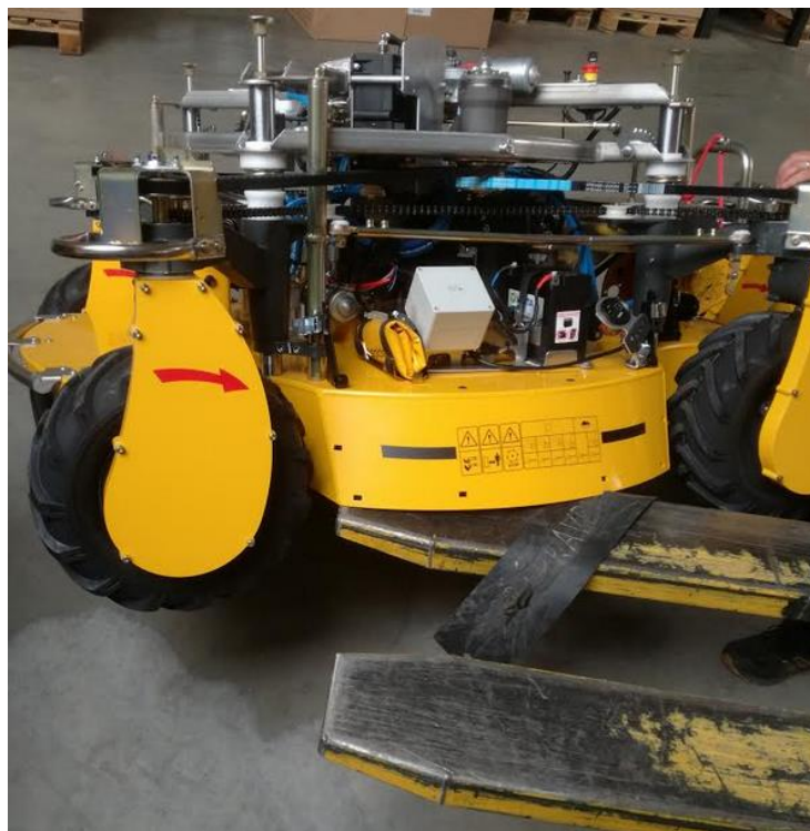
Obr. 2 Převrácení sekačky Spider ILD02 do servisní polohy pomocí vysokozdvizného vozíku
