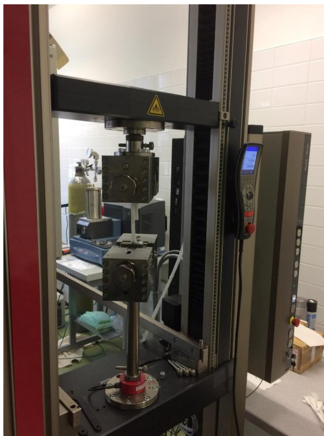
Obrázek 15 Experimentální uspořádání při tahovém testu na univerzálním měřicím zařízení v tahu a tlaku Z010
