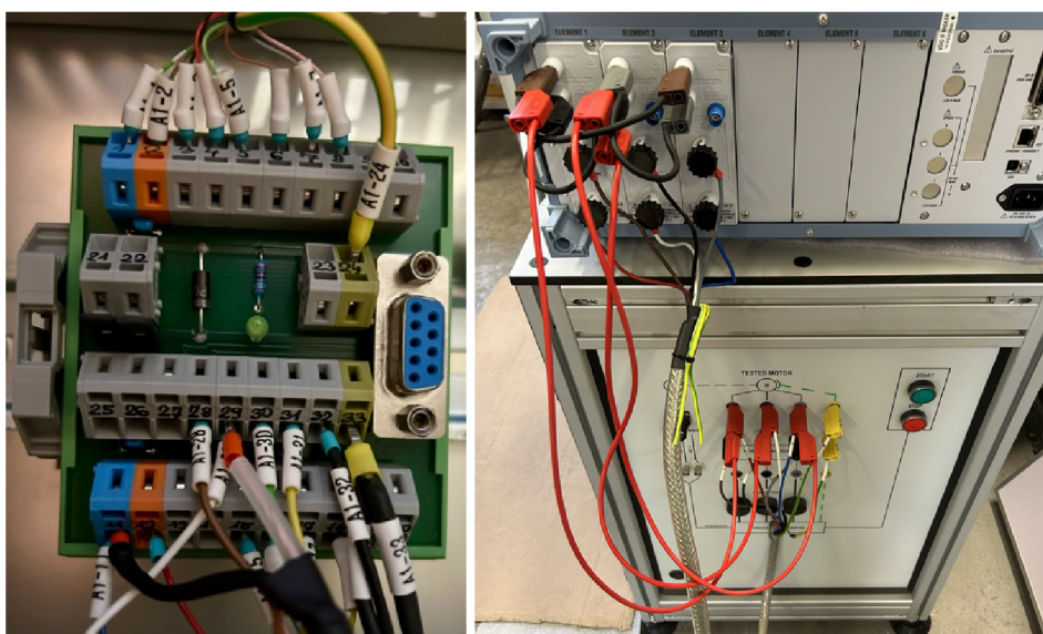
Obr. 7.3: Zapojení A) osciloskopické karty; B) výkonového analyzátoru
