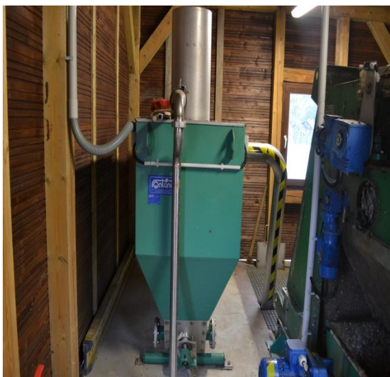
Obr. 6.4 - Separátor písku s integrovaným praním
