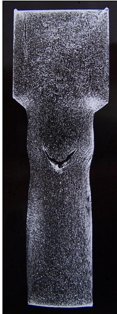
Obr. 13 Centrální trhlina v průtlačku [6]
