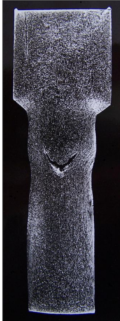
Obr. 13 Centrální trhlina v průtlačku [6]
