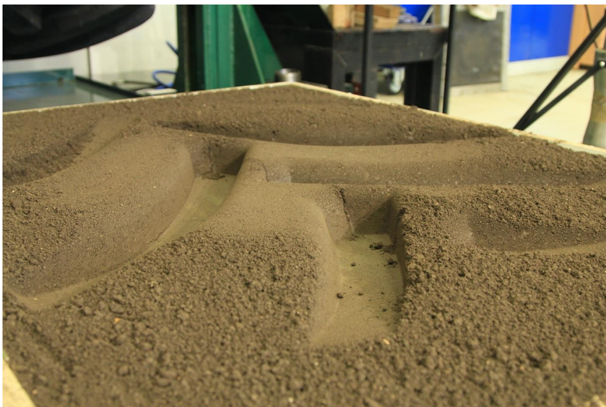
Obrázek 11: Ukázka z měření – otisk kontaktní plochy pneumatiky.
