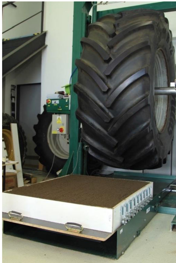
Obrázek 10: Laboratorní zařízení pro testování otisků styčné plochy na měkkém povrchu.
